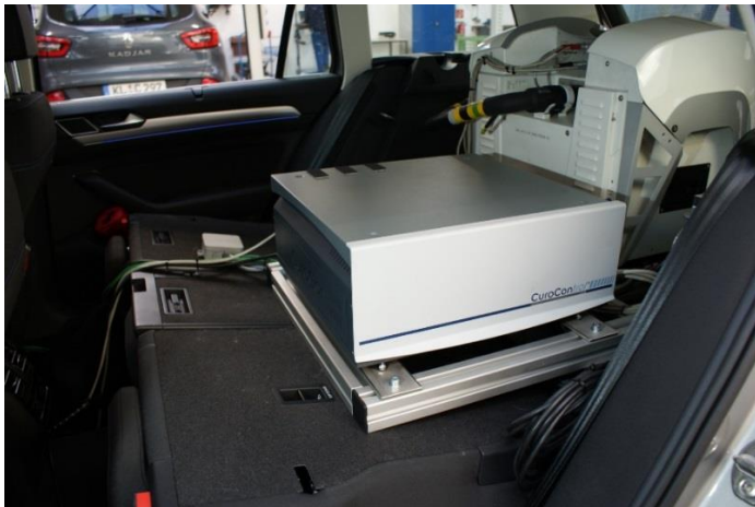
Bild 3: Messsystem CuroControl® Mx für das zentrale Datenmanagement
