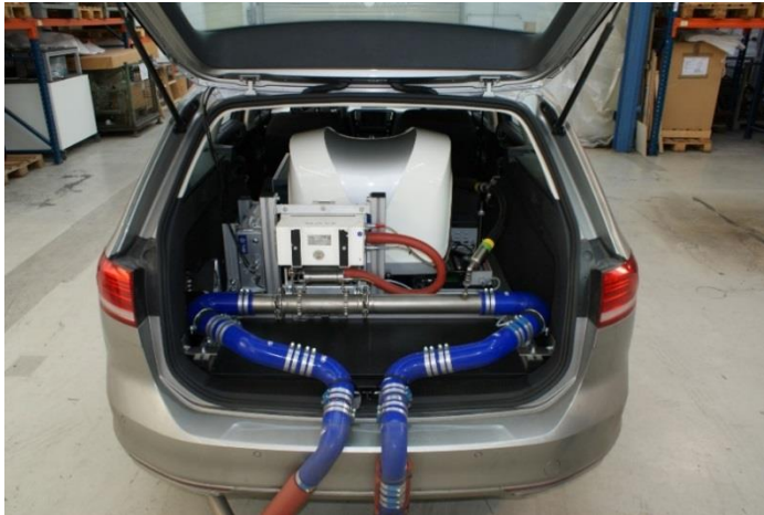
Bild 2: Einbau des mobilen Emissionsmessgeräts im Fahrzeugkofferraum
