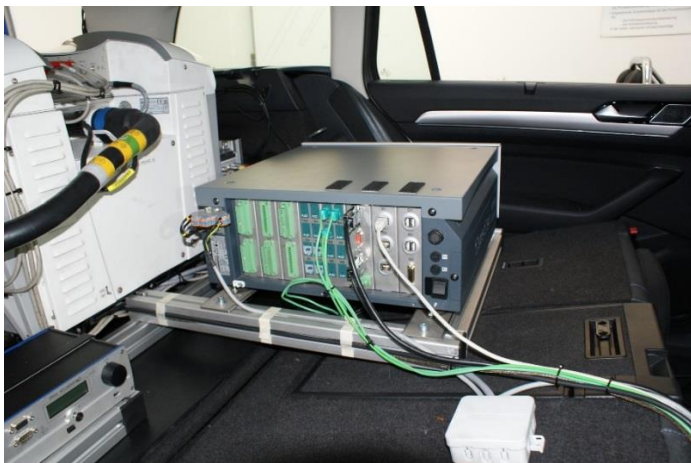
Bild 4: Schnittstellenleisten auf der Rückseite der Messbox
